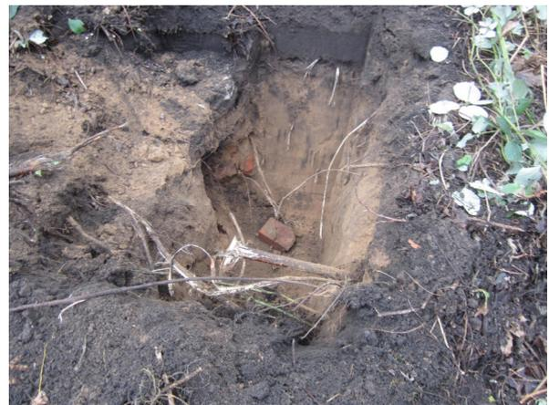
Abbildung 14: Schurf 2 im östlichen Böschungsbereich
