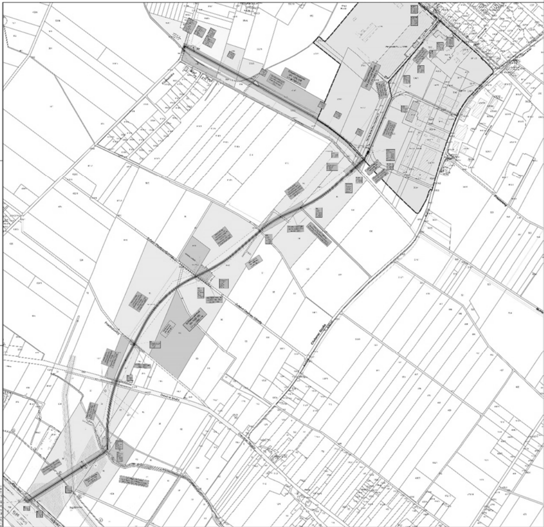
Übersichtslageplan: Kanalbau in Coswig OT Neusörnewitz mit Stauraumkanal und RW-Entlastungskanälen, ohne Maßstab (ACI Aquaproject Consult Ingenieurgesellschaft im Auftrag von Eigenbetrieb Kommunale Dienste Coswig, Stand 30.03.2021)
